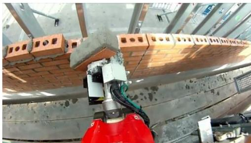
Рис.1 - Робот для монтажа элементов зданий
