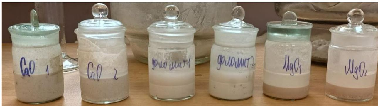
Рисунок 2 – Огнеупорные сыпучие материалы, затворенные водой.
