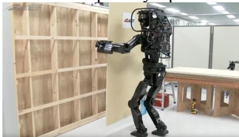
Рис.3 - Робот для выполнения облицовочных работ
