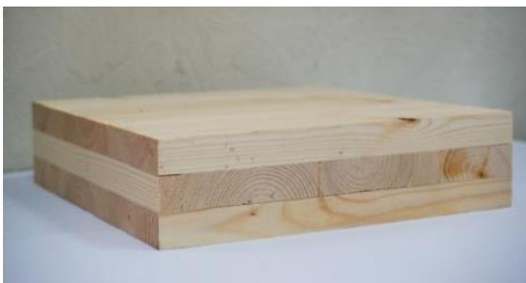
Рисунок 1 – Многослойная клеёная деревянная панель, сфабрикованная тремя слоями из сосны
