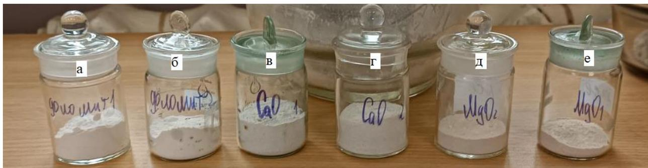
Рисунок 1 – Внешний вид огнеупорных сыпучих материалов: а–б – обожженный доломит ( $\text{CaO}+\text{MgO}$ ); в–г – известь ( $\text{CaO}$ ); д–е – периклаз ( $\text{MgO}$ ).
