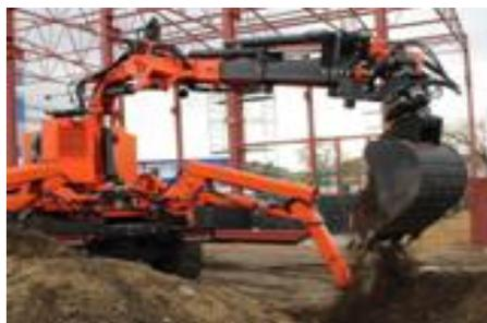
Рис.4 - Манипулятор для производства земляных работ
