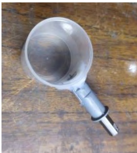
Рисунок 2. Шаблон для точной разметки полипропиленовых труб
