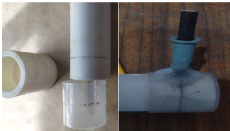
Рисунок 3. Отметка с помощью шаблона
