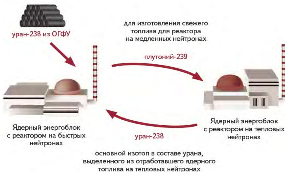
Рисунок 1 – Замкнутый ядерный топливный цикл с ректорами на быстрых нейтронах
