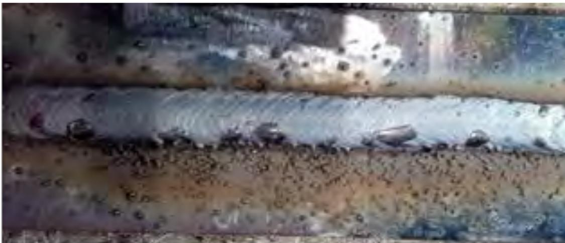
Рисунок 3. Внешний вид шва, полученного дуговой сваркой в  $\text{CO}_2$
