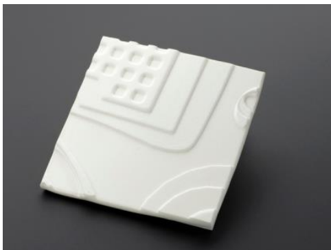
Рисунок 4. Образец материала с памятью формы, используемого в исследованиях и разработках летальных аппаратов.
