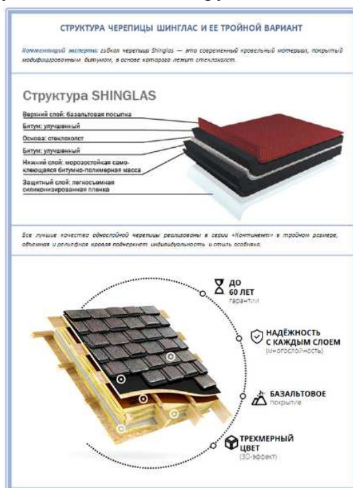
Рисунок 2. Структура черепицы SHINGLAS
