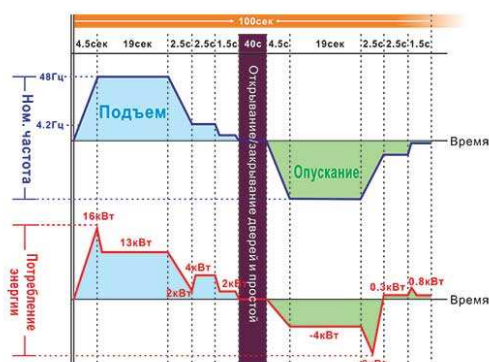
Рисунок 5 – Нагрузочная диаграмма лифтовой установки
