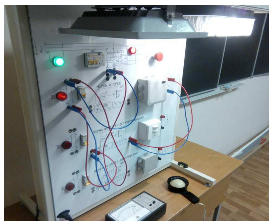
Рисунок 1– Процесс измерения освещенности на лабораторном стенде
