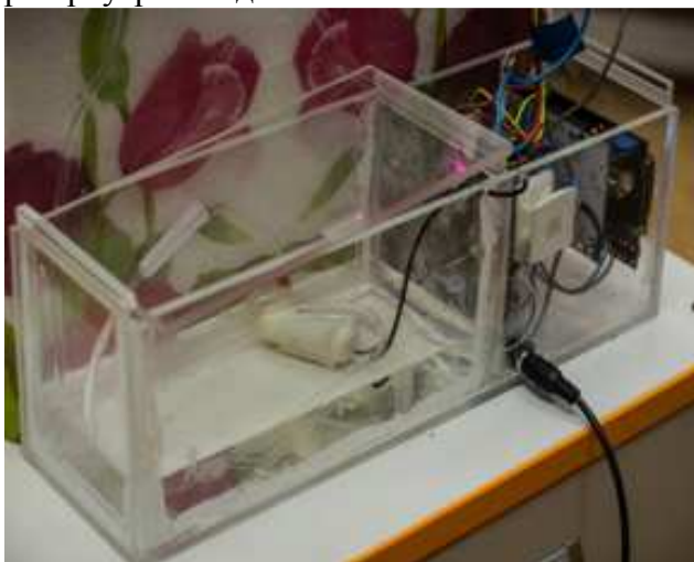
Рисунок 2 – Блок управления и резервуар для воды
