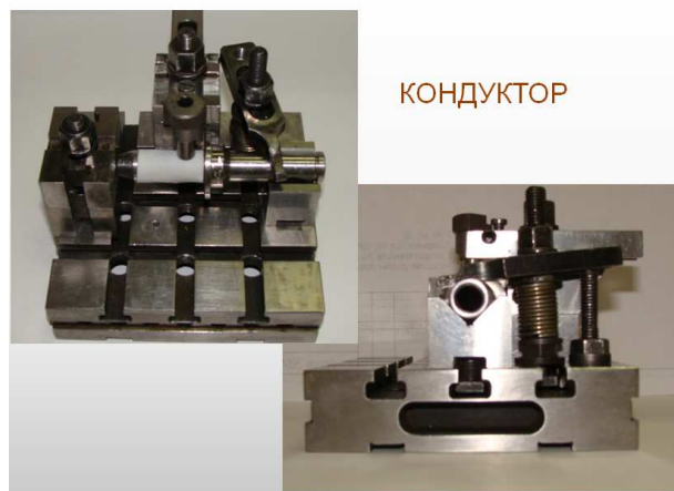
Рисунок 2 – Сборка приспособления «Кондуктор»
