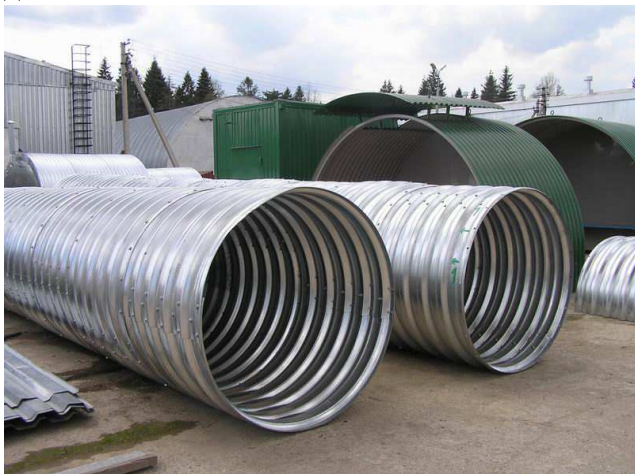
Рисунок 1 – Склад спиральновитых гофрированных металлических труб
