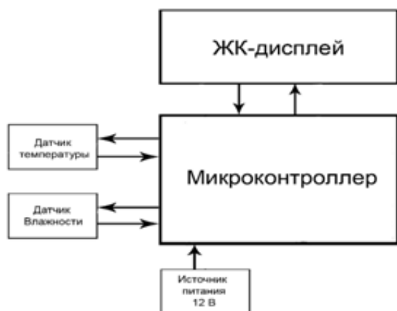
Рисунок 1 – Структурная схема домашней метеостанции
